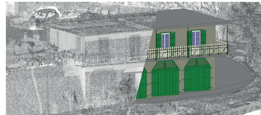
**La modélisation 3D est le processus de création d'un modèle tridimensionnel d'un bâtiment via un scanner.** Grâce à cette technologie, il est possible de reproduire virtuellement la taille, la forme et la texture de n'importe quel bâtiment. Les scanners utilisés par EXID numérisent plus d'un million de points à la seconde.
